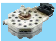
Разпределител за гориво Много увреждания по корпуса или резбите (деформация, пукнатини)
