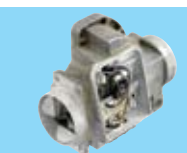
Разходомер за въздух Увреден потенциометър или датчик за температура
