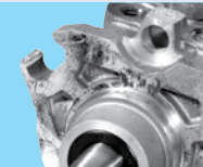
Водещият вал или фланецът е повреден
