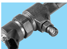
Увредена уплътнителна повърхност или корпус
