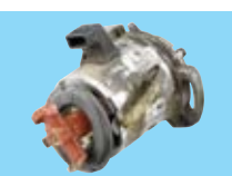
Разпределител на запалителната система Увреден вакуумен блок, монтажна пластина, запалителен модул, разпределителен вал, дистрибуторната капачка липсва, щекера липсва
