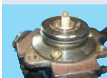
Увреден водещ вал или фланец
