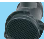
Въздухомер с горещ слой Увреден корпус на цилиндъра, филтърен елемент или винтове (извадени винтове, в лошо състояние)
