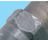
Увреден корпус, уплътнителни повърхности или тръба
